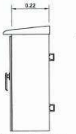
ตู้ควบคุมชนิดแขวน • มีวงจรภายในตู้ทั้งหมดในแบบก่อสร้าง
