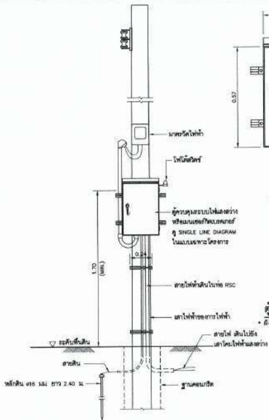
แบบรายละเอียดการติดตั้งอุปกรณ์ไฟฟ้าที่เสาไฟฟ้า มาตรฐาน 1:25 ข้อแนะนำ ตู้ควบคุมไฟฟ้าชนิดแขวน ใช้สำหรับระบบไฟฟ้า 1 เฟส จำนวนวงจรน้อย 2 วงจร ดูรายละเอียดการติดตั้งในแบบเลขที่ พท-302/60
